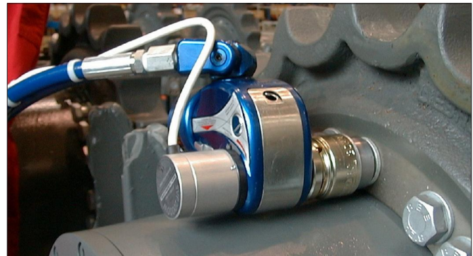
MXT-3 en el ensamble de una unidad Caterpillar, de acuerdo al ángulo de rotación seleccionado.
