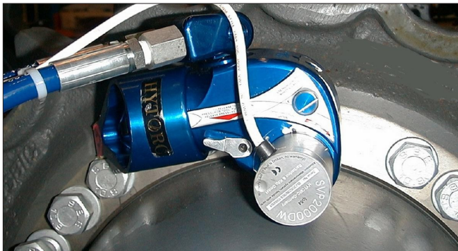
MXT-3 en el ensamble de una unidad Caterpillar, de acuerdo al ángulo de rotación seleccionado.
